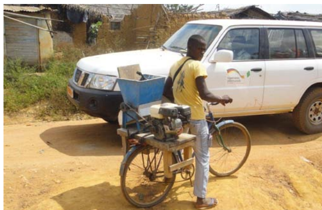
Broyeur mobile à râpe transporté en vélo, près de Soubré, en novembre 2014.
